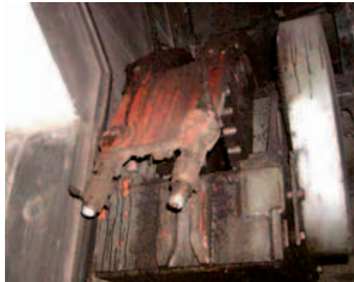
Detail utrženého závěsu. Pravděpodobná příčina je únava materiálu.
