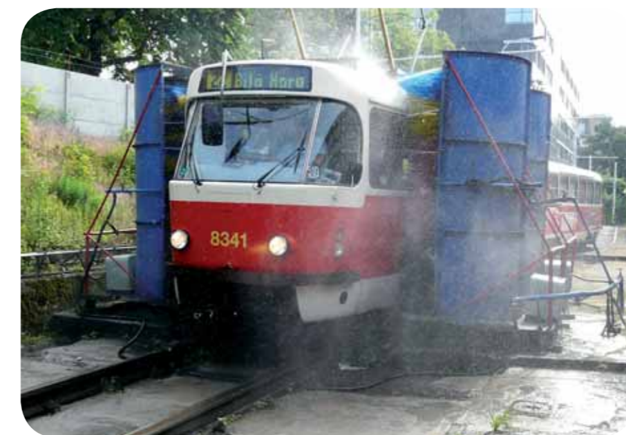
Nedávno zrekonstruovaný venkovní mycí rám tramvají na objízdné koleji
